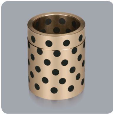
RGPBW 材料: 高力黄铜+ 固体润滑剂 Material: CuZn25Al5Mn3Fe3 + Graphite (500#SP)
